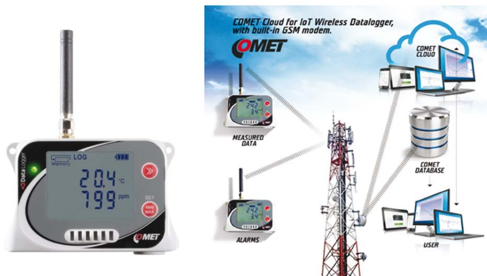
Rys. 8. Miernik i rejestrator COMET 4400M oraz jego współpraca z siecią GSM i internetem [5]
